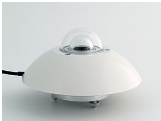
Slika 14. Piranometar je mjerni instrument koji mjeri ukupno Sunčevo zračenje (sa svim valnim duljinama), koje pada na neku vodoravnu plohu.
