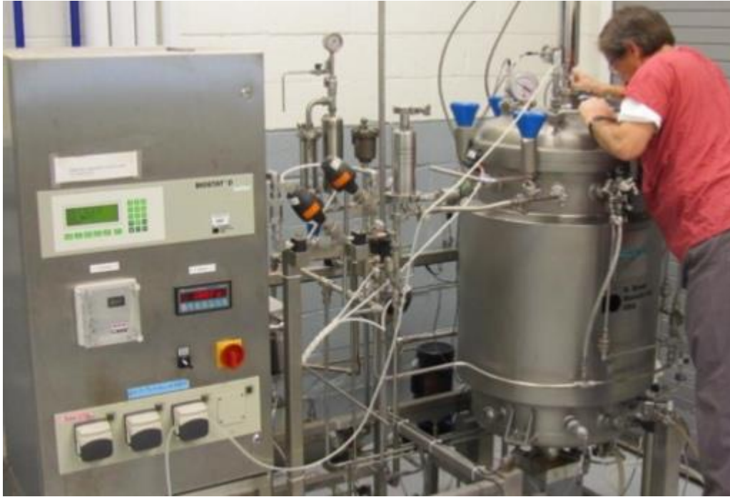
Veliki fermentator od 1500 L. Zasluge za fotografije: Dugway Proving Ground
